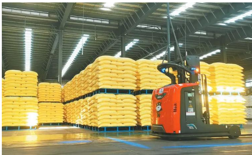
图为无人驾驶的智能叉车在心连心公司成品仓库昼夜不停地装运春耕肥料
